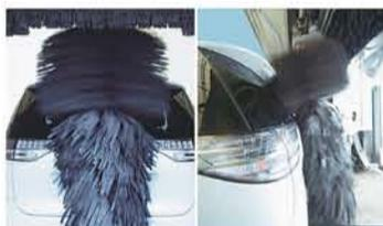
分割したブラシがリヤ部で15°に傾斜し、確実に洗浄
