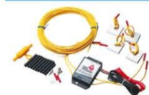
ラストアレスタは車の塗装の劣化や、サビの発生を防ぎ、車体の耐久年数をのばす、車両用「電子防錆システム」です。塗装の傷やミクロのピンホールにアノード(電極)から微弱電流を雨や結露時にできる水膜を通して流すことにより、金属に電子を補充してサビの発生を防ぐメカニズムです。乗用車から大型トラック、特殊車まで対応の製品ラインナップを揃えています。
