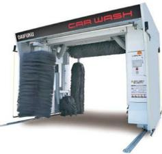
業界初、6本目のブラシ「フロントサイドブラシ」を洗車機前面に追加したことで、レーン長を従来より1.6m短くして1.6m短くして走行きの設置必要寸法を9.94mから8mに短縮。短縮装置なしで幅4m×走行き8mの省スペースに設置できるようにしました。(写真はシャンプー、撥水コーティングを標準搭載した「SSパッケージ」)
